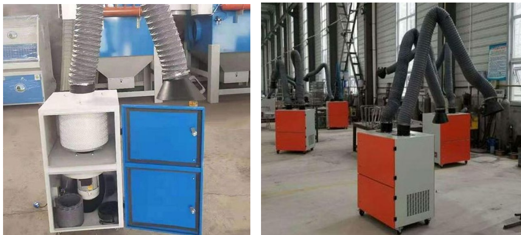
图 4-1 典型移动式滤筒除尘器样式
