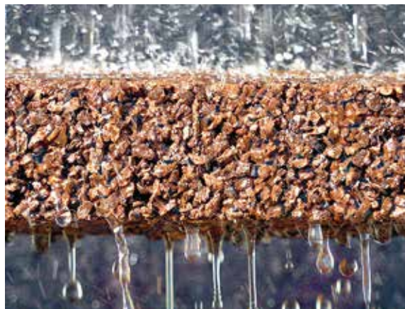
Elastopave 使路面稳定又具透水性。
