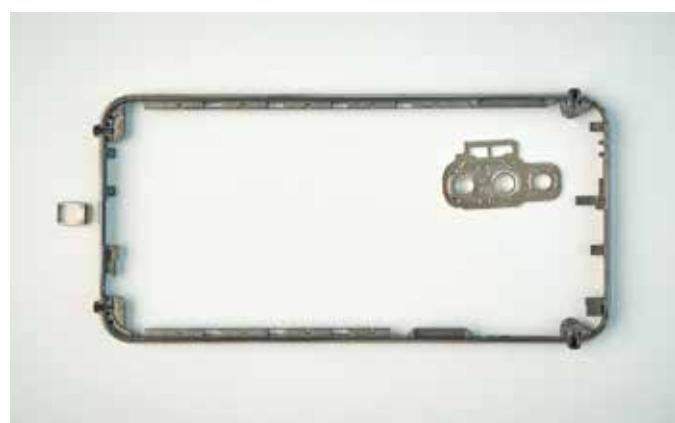
Catamold® 可以用于多种智能手机零件的制造。
