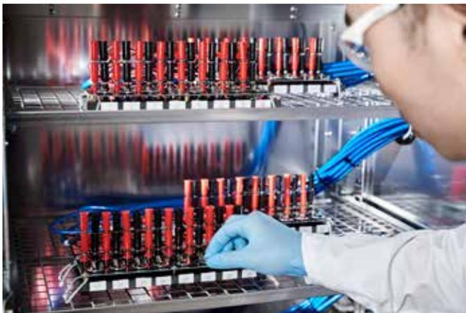
巴斯夫上海创新园的科研人员正在测试小型电池，为研究电动车动力电池在整个生命周期中的性能提供精确的数据支持。
