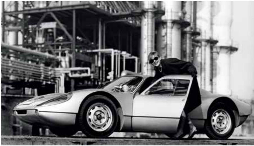
1964年，保时捷新车型904 卡雷拉 GTS 的外壳使用了巴斯夫塑料 Palatal。
