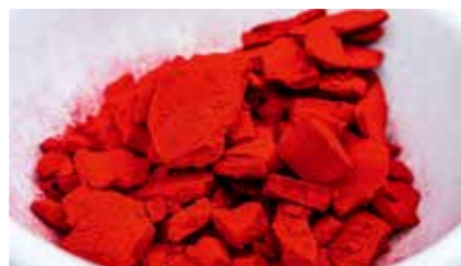
几克刚在实验室合成的吡咯并吡咯二酮类红色滤色颜料。扩大产能后，这种颜料正成吨生产。
