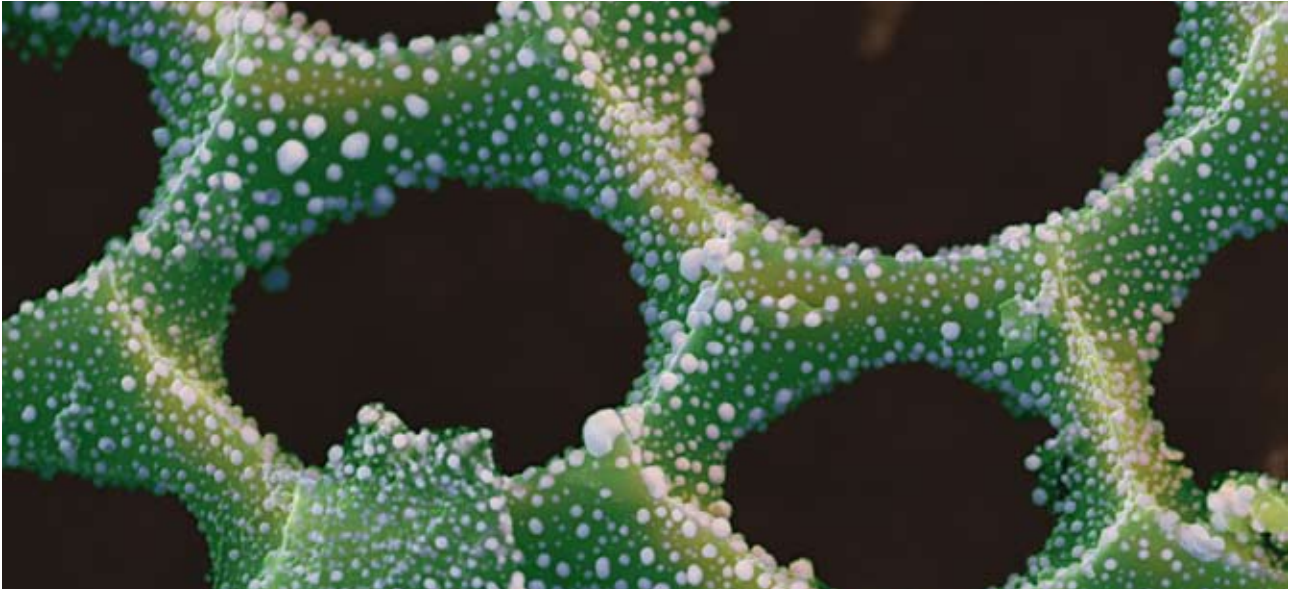
Die elektronenmikroskopische Aufnahme zeigt Silberkatalysatoren der BASF, die auf Kieselgur aufgebracht sind.
