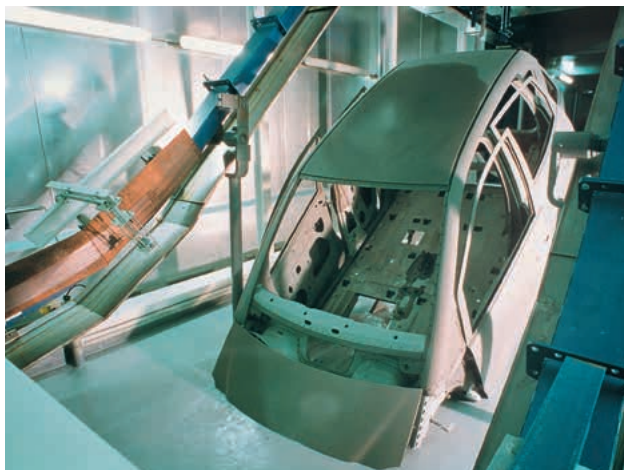
Bei der Tauchlackierung fährt die Karosserie durch ein Tauchbecken, in dem die Lackpartikel mit Hilfe von elektrischem Strom am Stahlblech abgeschieden werden.
