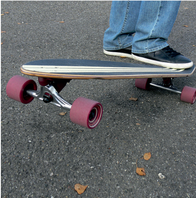
Auf rauem Untergrund sorgen breitere Rollen für die gewünschte Laufruhe.
