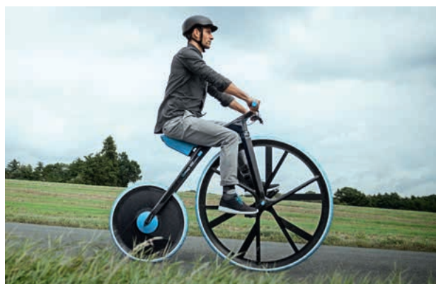
„Concept 1865“ besteht fast vollständig aus Kunststoffen der BASF. Nur die Bremse, die Achsen und der Motor sind noch aus Metall.
