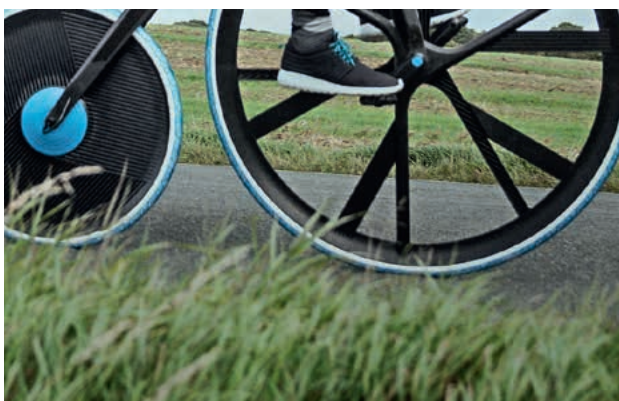
„Concept 1865“ besteht fast vollständig aus Kunststoffen der BASF. Nur die Bremse, die Achsen und der Motor sind noch aus Metall.
