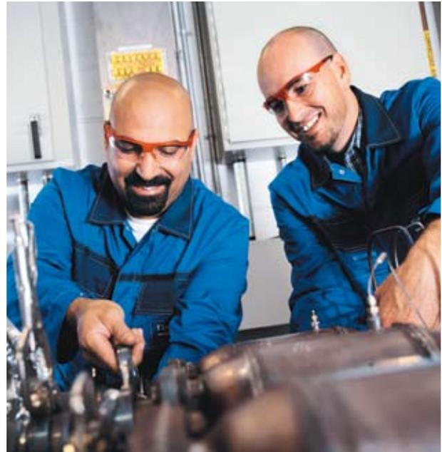
Im Testlabor für Katalysatoren der BASF in Union/New Jersey/USA bereiten Techniker **David Colon** (links) und **Andrew Thoms** einen Katalysator für einen Testlauf am Motorenprüfstand vor. In Labor- und Motorenprüfstunden werden Katalysatoren unter Dauerbelastung getestet. Moderne Prüftechnik ermöglicht es, die Lebensdauer eines Dreiwegekatalysators (Gesamtleistung zirka 190.000 Kilometer) in rund 50 bis 100 Stunden zu simulieren.
