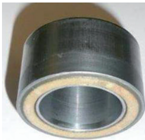
Prototype d'isolation d'une colonne de direction pour un véhicule compact.
