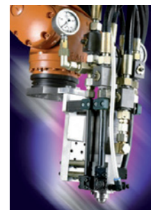
Tête de mélange d'une machine de dosage polyuréthane.
