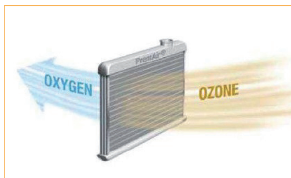
Transformation de l'Ozone en Oxygène via l'utilisation du catalyseur PremAir® .
