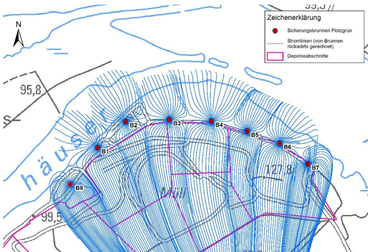
Abbildung 5: Zuflussverteilung zu den Abschirmbrunnen gemäß Grundwassermodell [7]
