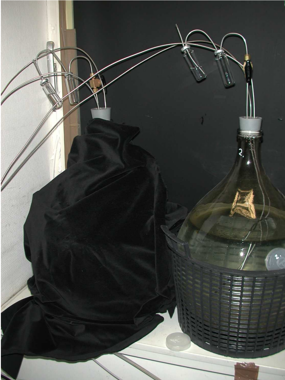
Abb. A-2: Vorratsbehälter mit Standortwasser. Der Behälter mit dem dotierten Wasser wird durch ein lichtundurchlässiges Tuch vor Lichteinstrahlung geschützt um einen photolytischen Abbau von Mecoprop und Bentazon zu verhindern.
