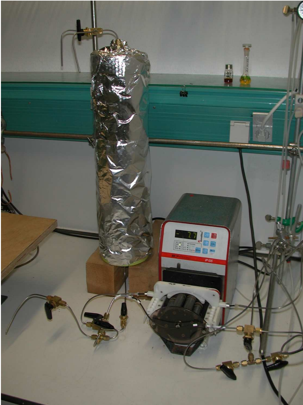
Abb. A-1: Versuchsaufbau. Liner ist durch Alufolie vor Lichteinstrahlung geschützt um einen photolytischen Abbau von Mecoprop und Bentazon zu verhindern.
