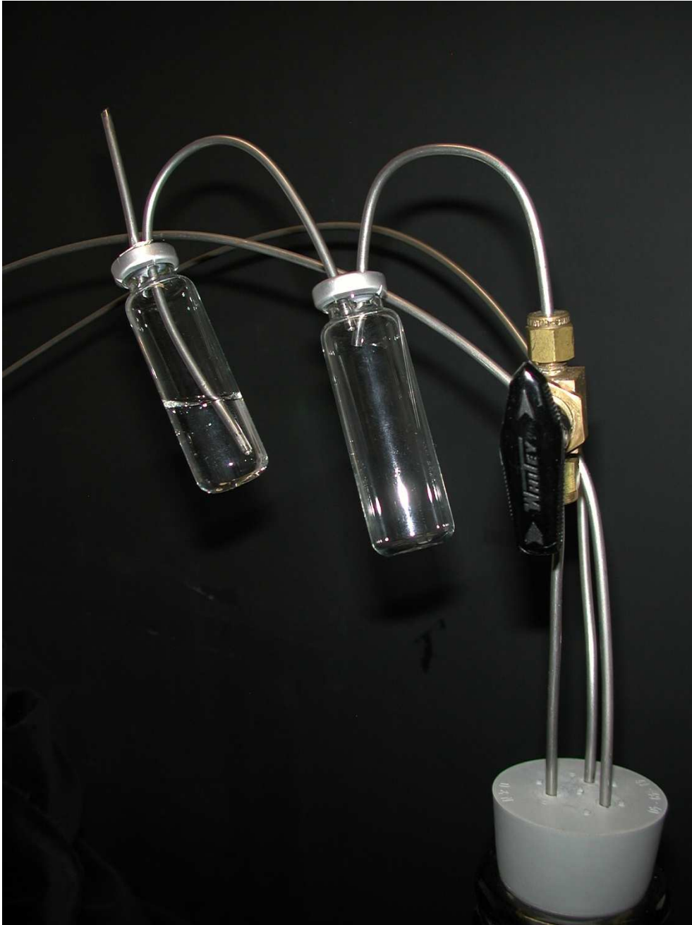
Abb. A-3: Rückschlagventil ermöglicht den Austritt von Stickstoff beim Begasen des Wassers und verhindert den Zutritt von Sauerstoff.
