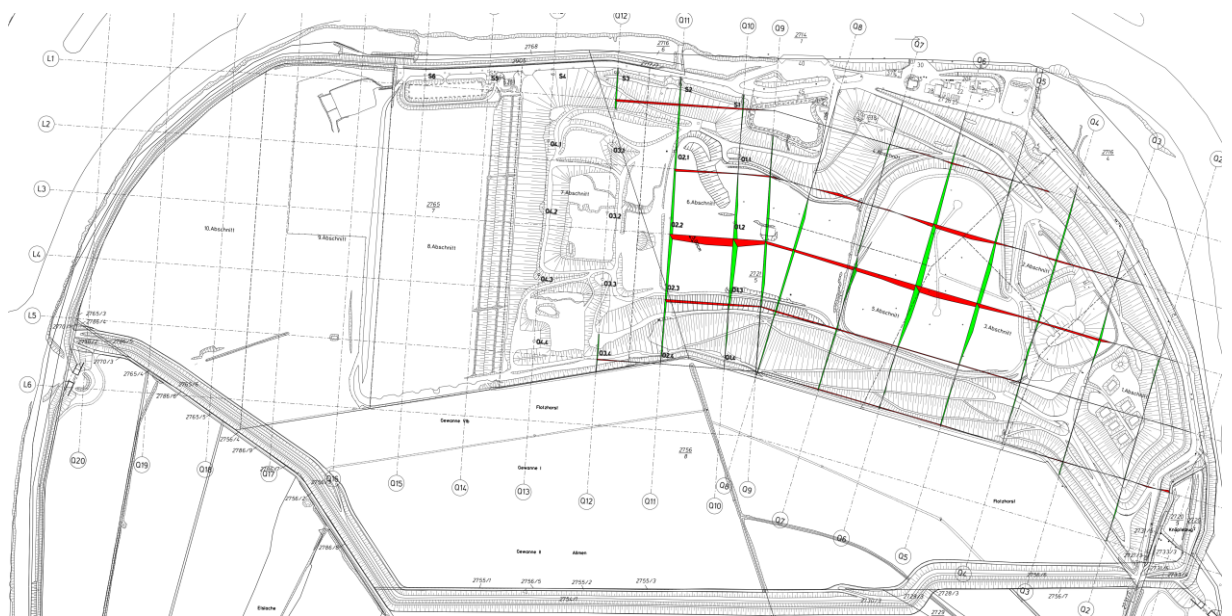
Lageplan 2: Ergebnis der Setzungsmessungen 2021
