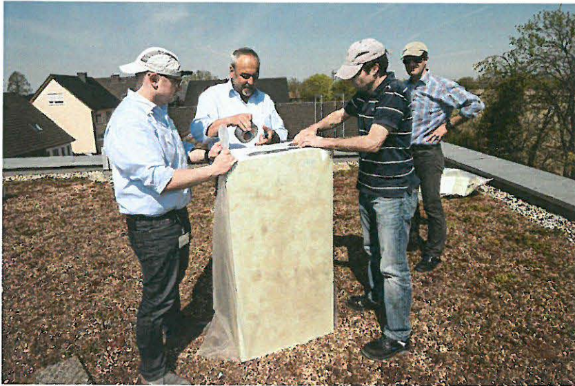
Bild 8: Entnahmestelle 1 und 2 Die entnommenen Proben wurden sofort in Kunststoffolie verpackt und dem FIW München übersandt
