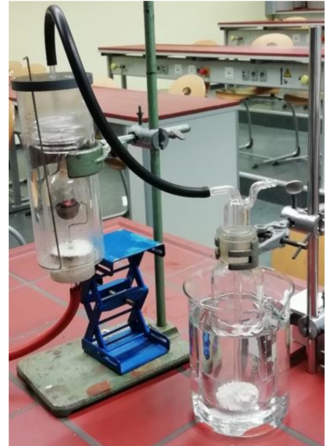
Versuchsaufbau zur Bestimmung der Wassermasse
