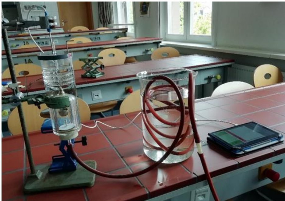
Versuchsaufbau zur Bestimmung der Reaktionswärme
