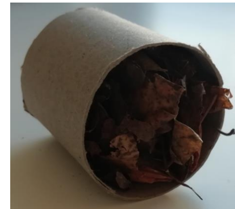
In eine Hülle gepresstes Brikett
