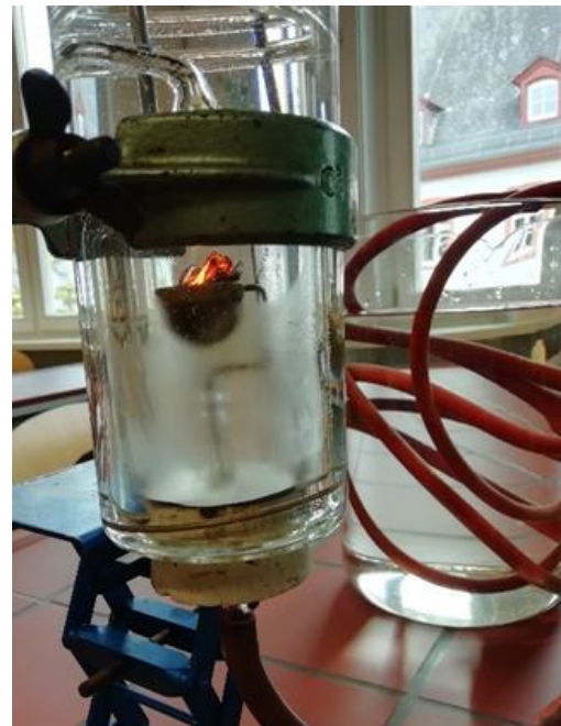
Versuchsaufbau zur Bestimmung der Reaktionswärme
