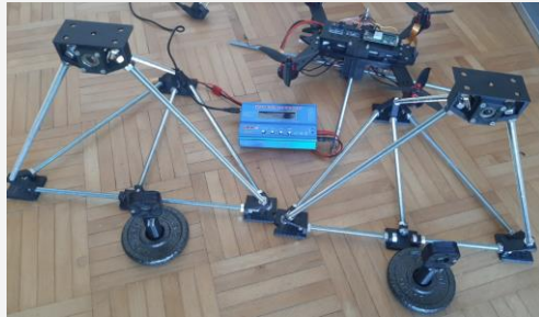
Wippen und Halterungen zum Testen
