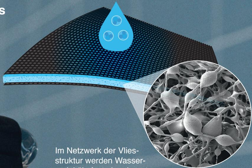
Im Netzwerk der Vliesstruktur werden Wassermoleküle fest eingelagert. Bei Wärmeeinwirkung verdunsten sie und kühlen dadurch den Körper.
