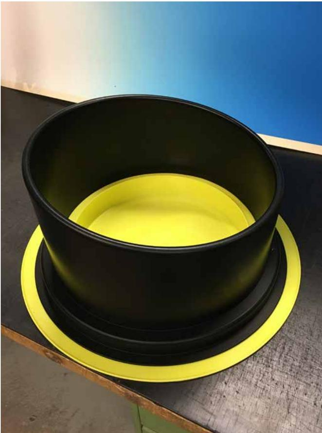
Mit dem einzigartigen, zum Patent angemeldetem Produkt und Verfahren, verfügt BASF über die Möglichkeit, Metallbauteile der komplexesten Geometrien reproduzierbar mit einer elektrostatisch ableitfähigen PFA-Schicht zu versehen.
