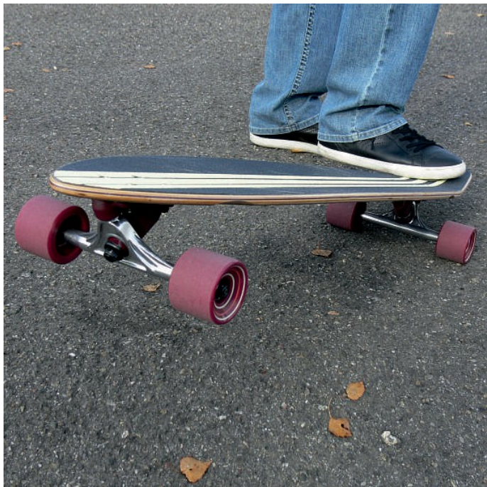
在粗糙路面上，滚轮越宽，滑行起来越平稳。
