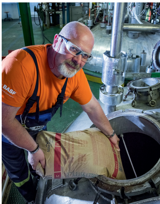
Carico di materie prime all'interno di un reattore.
