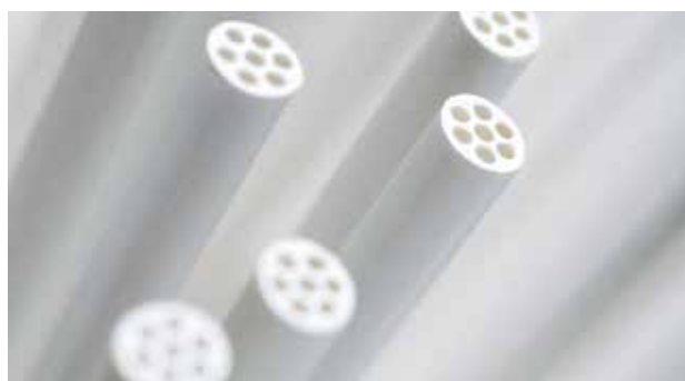
I filtri a membrana usati negli impianti di desalinizzazione presentano piccolissimi pori di soli 20 nanometri di diametro, in grado di catturare particelle e patogeni.
