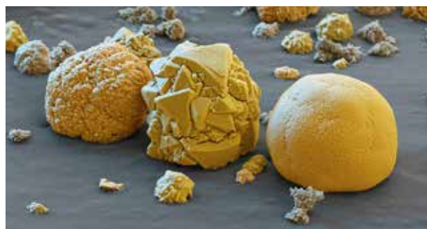
I materiali catodici utilizzati per le batterie al litio contengono piccole sfere di pochi micrometri. Queste particelle sono progettate per offrire, nelle diverse applicazioni, le migliori prestazioni possibili in termini di accelerazione e autonomia del veicolo elettrico (ingrandimento 6.400:1).
