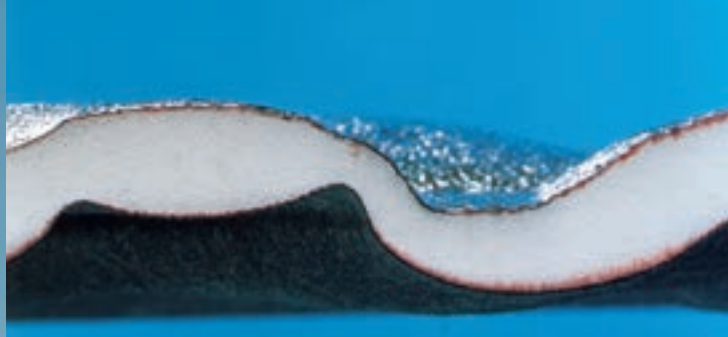
アルミホイルとフェルトでラミネートした成形加工パーツ
