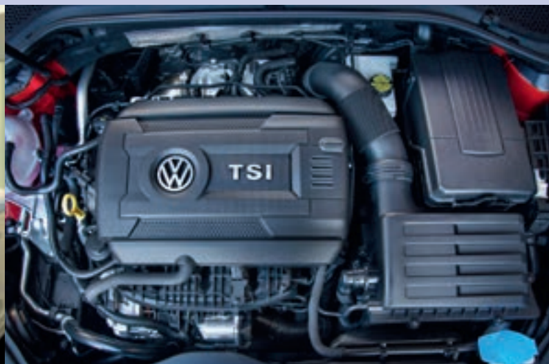
Volkswagen EA888エンジンカバー吸音材, 北米 写真:VW/BASF
