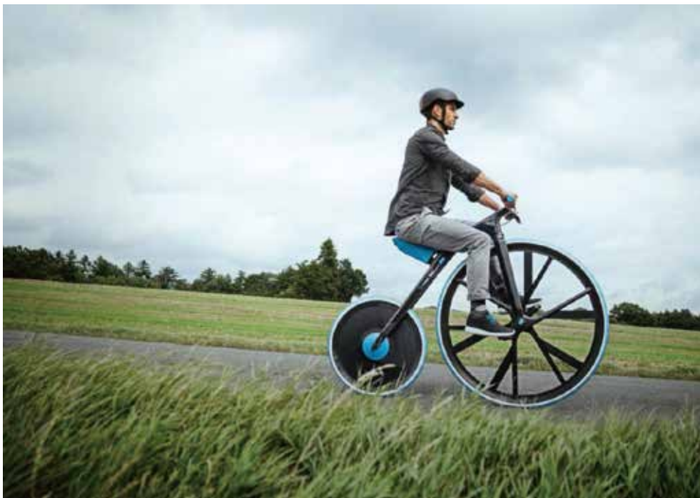
「概念 1865——材料再思考」的電動自行車，由 24 種尖端特性塑膠材料製造，最高可減重 60%。
