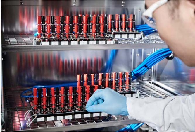
巴斯夫上海創新園的科學研究人員正在測試小型電池，為研究電動車動力電池在整個生命週期中的性能提供精確的資料支援。
